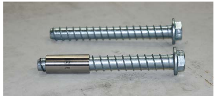
Hülse lässt sich komplett aufstecken, Anker für Wiederverwendung nicht mehr geeignet
